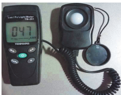
Slika 1. Mjerni instrument TENMARS Lux/Fc Light Meter TM-201
